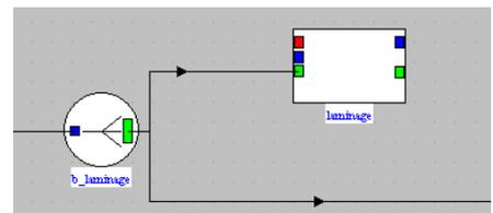
Dans un laminage, l'exergie totale du fluide diminue entre l'entrée et la sortie du composant, du fait de la baisse de pression à enthalpie constante. Il faut placer en amont un embranchement. Il s'agit d'un composant dissipateur d'exergie. La ressource est la diminution d'exergie  $\Delta xh^+$  du fluide qui le traverse (représentée par un lien entrant dans le port vert), et le produit est égal à 0.
