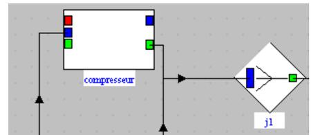
Un compresseur (ou une pompe) convertit la puissance mécanique  $\tau^+$  qu'il reçoit en accroissement d'exergie  $\Delta xh$  du fluide qui le traverse. Il faut donc placer en aval une jonction dont les autres entrées sont par exemple le comburant et la chambre de combustion. Le lien sortant provient du port vert.
