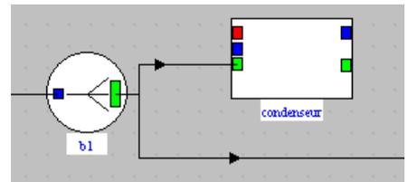
Dans un refroidissement avec une source externe à température supérieure à celle de l'environnement, la ressource est la diminution d'exergie  $\Delta xh^+$  du fluide qui le traverse (représentée par un lien entrant dans le port vert), et le produit est l'exergie-chaleur cédée par le système à la source externe, dont la température de la source externe doit être indiquée dans l'écran de calcul exergétique. Il faut placer en amont un embranchement avec au moins une autre sortie.
