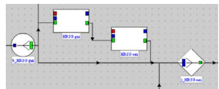
Dans un échangeur modélisé en interne comme couplage entre deux transfos "échange", la ressource correspond à la variation d'exergie du fluide chaud, et le produit à celle du fluide froid. Il en résulte que le fluide chaud doit correspondre à l'une des branches d'un embranchement, et le fluide froid à l'une des branches d'une jonction. Les deux composants sont reliés comme indiqué sur la figure.
