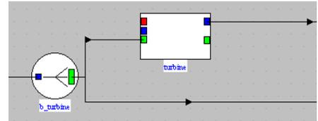
Une turbine convertit en puissance mécanique  $\tau$  la diminution d'exergie  $\Delta xh^+$  du fluide qui la traverse (représentée par un lien entrant dans le port vert). Il faut donc placer en amont un embranchement avec au moins une autre sortie, par exemple un rejet à l'atmosphère des gaz détendus, ou un condenseur s'il s'agit d'une vapeur. Le lien sortant représentant le travail provient du port bleu.
