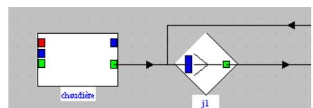
Dans un échange avec une source externe à température supérieure à celle de l'environnement, apportant de chaleur au système, la ressource est l'exergie-chaleur  $xQ^+$  échangée avec la source. Le produit est l'accroissement d'exergie  $\Delta xh$  du fluide qui traverse le composant. Il faut placer en aval une jonction. Le lien sortant provient du port vert.
