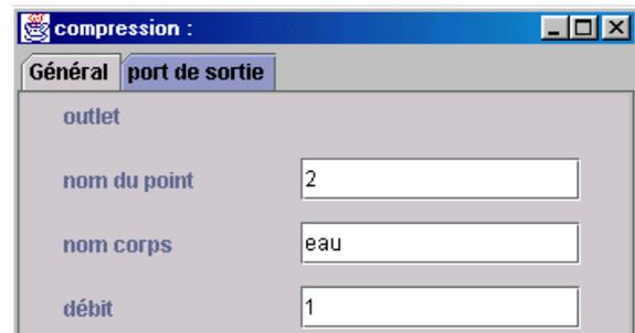
Cliquez ensuite sur l'onglet du port de sortie, et entrez le nom du point de sortie (2), le nom du corps (eau), et le débit (1 kg/s). Cliquez ensuite sur le bouton "Appliquer" pour valider les deux onglets. Le composant apparaît à l'écran :
