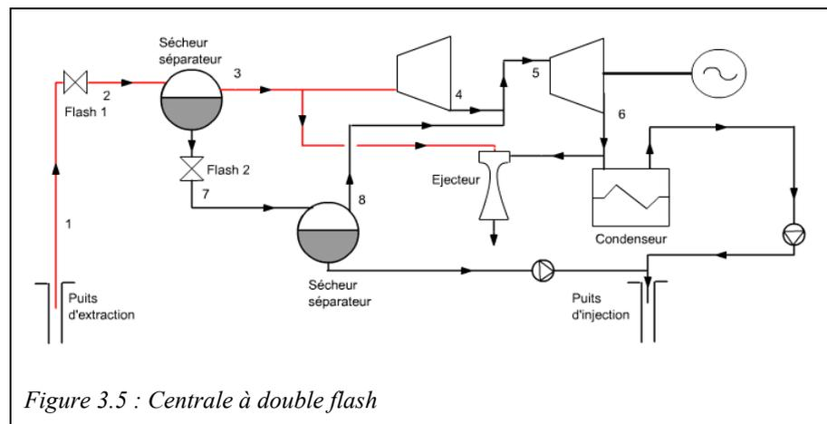
La phase liquide est recomprimée et réinjectée, tandis que la phase vapeur est mélangée au flux de vapeur issu du premier flash et détendue à la même pression.
