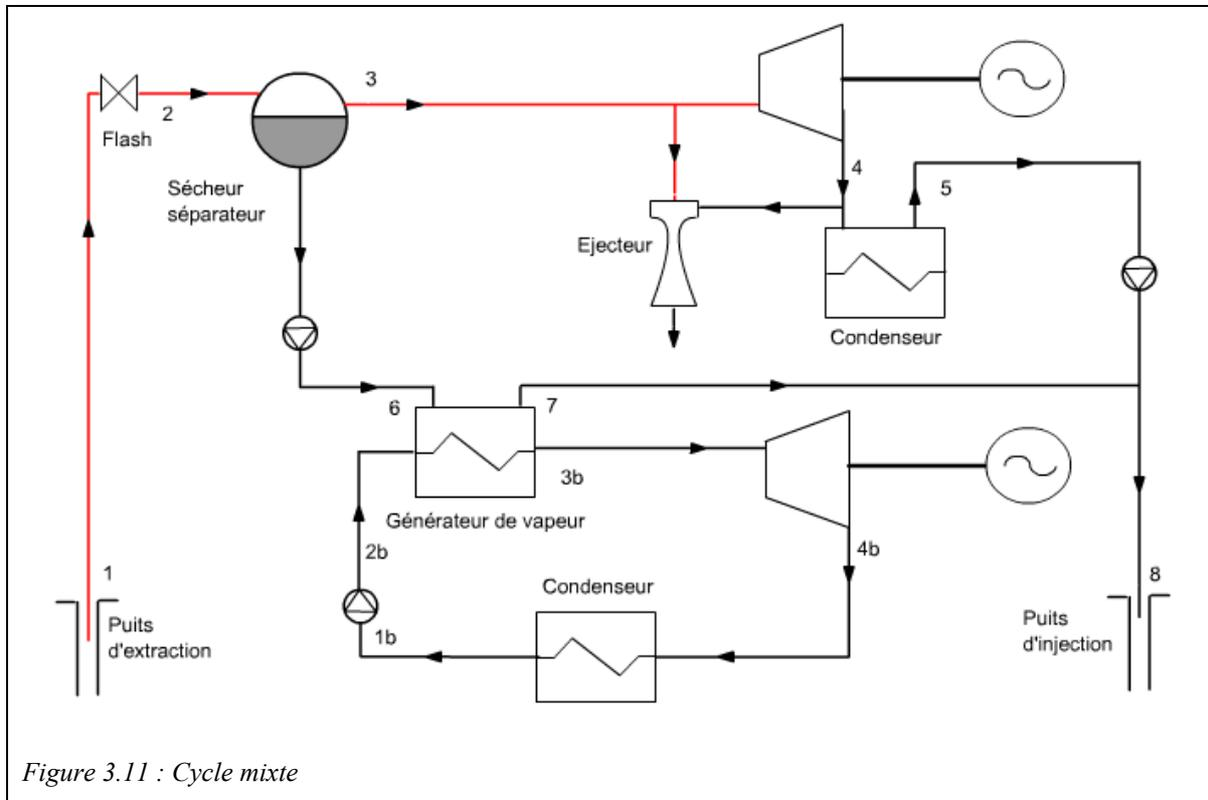
L'un des principaux inconvénients des cycles à flash est qu'ils n'exploitent qu'une faible part du débit total de fluide géothermique, celle correspondant à la fraction vapeur après le ou les flash, la fraction liquide étant réinjectée.
