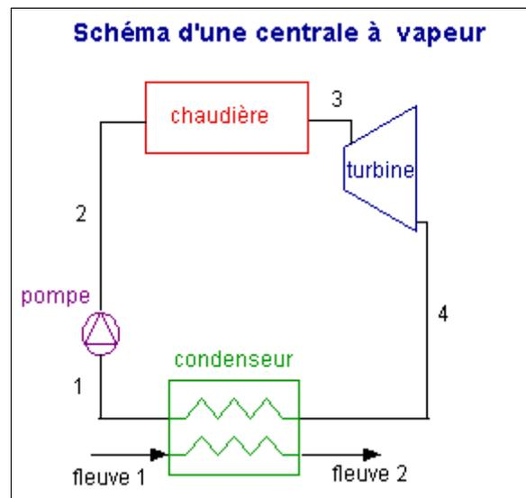
Dans ces conditions, le travail de compression devient quasiment négligeable devant le travail de détente (alors qu'il en représente environ 60 % dans une turbine à gaz). Le liquide comprimé est vaporisé et surchauffé dans la chaudière par échange thermique avec la source chaude, puis détendu et condensé.
