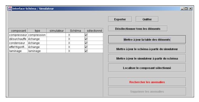
Pour transférer dans le simulateur l'ensemble des composants, cliquez sur le bouton "Mettre à jour le simulateur à partir du schéma". Un nom vous est demandé pour le projet. Entrez par exemple "cycle frigo". Une fois le transfert réalisé, l'écran de projet apparaît comme suit :
