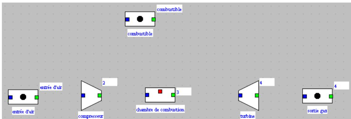
Vous pouvez alors commencer à connecter entre eux ces composants. Pour cela, cliquez sur le port de sortie (vert) de l'un d'entre eux (par exemple le compresseur), et faites glisser la souris jusqu'au port d'entrée du composant auquel il doit être relié (ici l'économiseur), et relâchez le clic. Un lien orienté apparaît alors :
