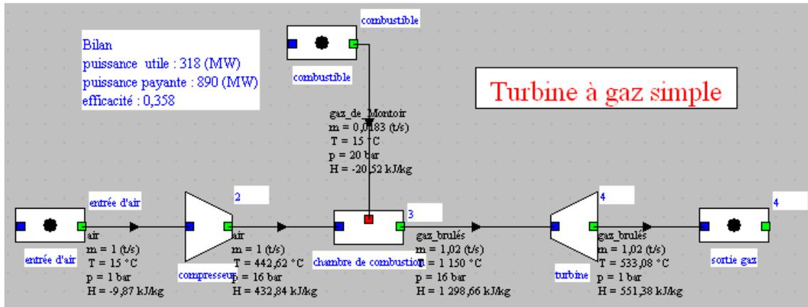
C'est ici que la présence des transfo-points "entrée d'air" et "sortie gaz" trouve son principal intérêt : elle permet de représenter les points "entrée d'air" et "4" par des liens orientés, et d'en afficher l'état.
