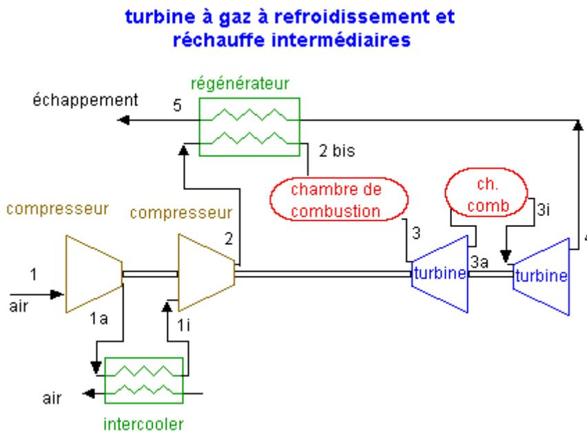
1 t/s d'air aspiré à 15 °C et 1 bar est comprimé à 4 bar dans un premier corps de compression, puis refroidi par échange avec l'air ambiant, avant d'être porté à 16 bar dans un deuxième compresseur. Il entre alors dans un régénérateur qui lui permet de récupérer une partie de l'enthalpie disponible en fin de détente.
