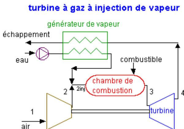
Un débit massique d'air de 1 t/s est aspiré à 1 bar et  $T_1 = 294$  K, puis comprimé à 16 bar par un compresseur de rendement polytropique égal à 0,85. En entrée de chambre de combustion, on injecte un débit  $\alpha$  d'eau à 20 bar et 400 °C. Le mélange est brûlé dans la chambre de combustion avec du gaz naturel de composition molaire :
