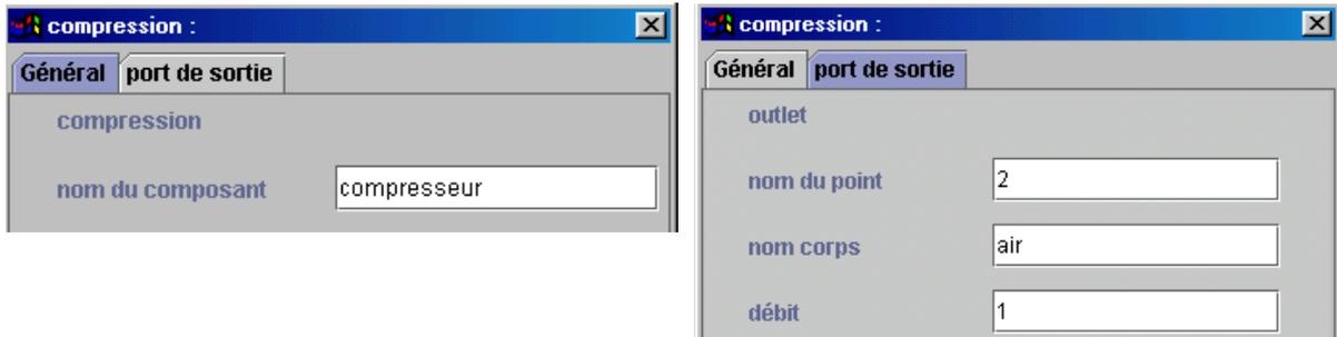
Cliquez ensuite sur l'onglet du port de sortie, et entrez le nom du point de sortie (2), le nom du corps (air), et le débit (1 t/s). Cliquez ensuite sur le bouton "Appliquer" pour valider les deux onglets. Le composant apparaît à l'écran :
