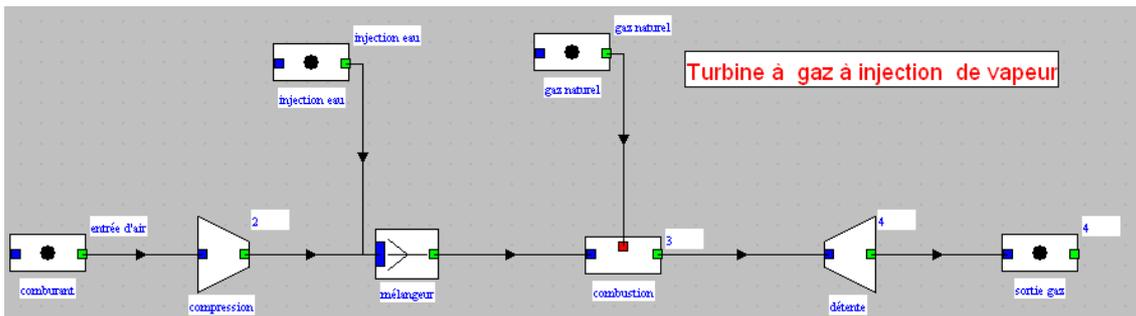
Le schéma du cycle est proche de celui de la turbine à gaz simple. Il s'en distingue par l'existence d'un mélangeur en amont de la chambre de combustion. Pour le construire, il faut ajouter une transfo-point pour l'injection d'eau, et un mélangeur, dont les deux branches sont le compresseur d'air et l'injection d'eau, et la veine principale la chambre de combustion.
